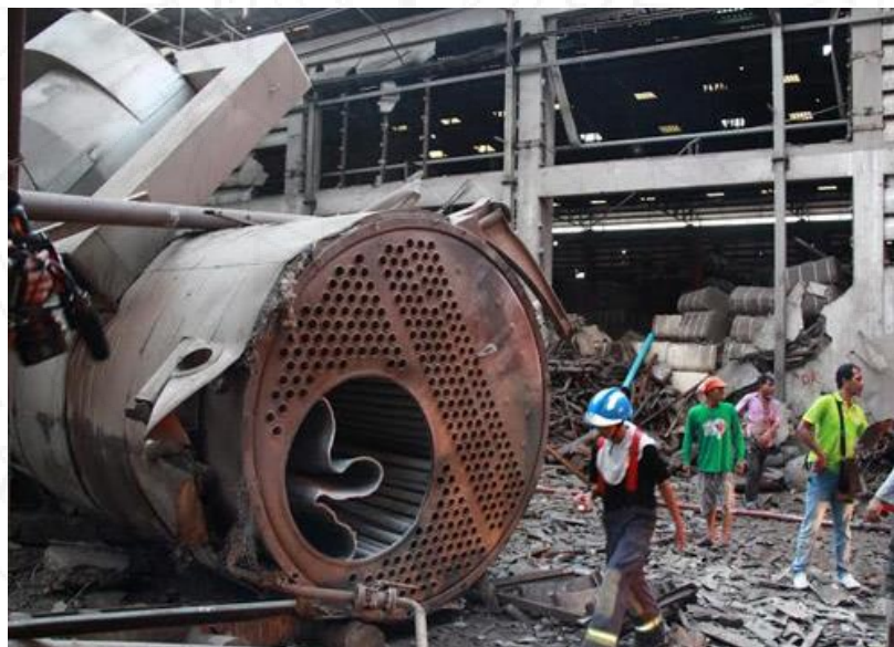
รูปที่ 2.8 แสดงรูปถังไอน้ำบริษัทซ่อมผ้าระเบิด ที่มา : http://www.accident.in.th/topic.html
