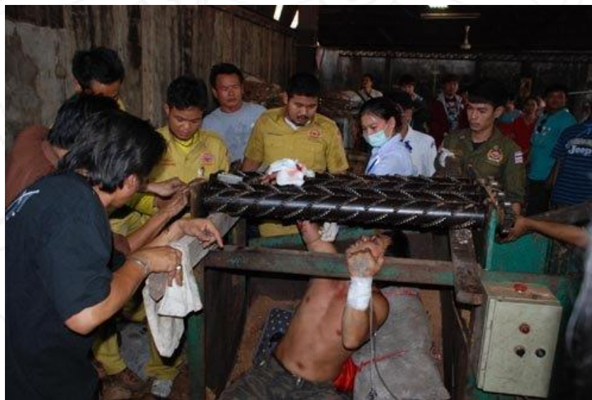
รูปที่ 2.2 แสดงรูปอุบัติเหตุจากการถูกหนีบโดยเครื่องปอกมะพร้าว
