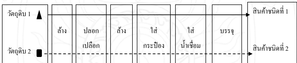
รูปที่ 4.2 แสดงการวางผังโรงงานตามชนิดของสินค้า
