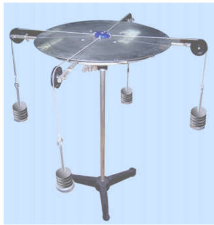
รูปที่ 3.4 แสดงชุดรอกพร้อมสกรูยึดแขนรอกของโต๊ะแรง
