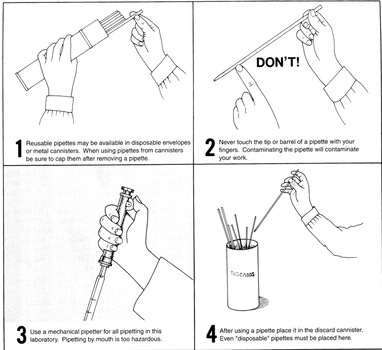
ภาพที่ 4 ข้อควรปฏิบัติในการใช้ปิเปตในการถ่ายเชื้อ
