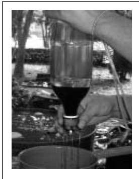
รูปที่ 3 แยกกลีเซอรินออกจากน้ำมัน
