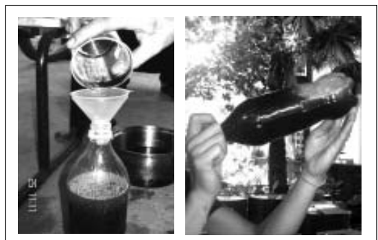
รูปที่ 2 ผสมสารละลายในขั้นตอนที่ 1 กับน้ำมันพืชที่ใช้แล้ว
