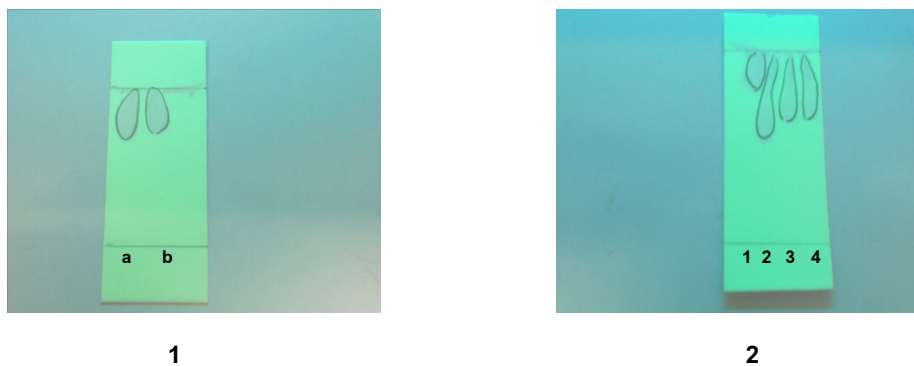
รูปที่ 4: (1) แสดงน้ำมันไบโอดีเซลตัวอย่าง (a) จำนวนร้อยละเมทิลเอสเทอร์ตามสูตรจากสมการเส้นตรงด้วยเทคนิค TLC ได้ 95.18 % ค่าที่วิเคราะห์ได้จริงจาก 1 H-NMR ได้ 96.0 % และค่า R f = 0.835 (b) น้ำมันไบโอดีเซลมาตรฐาน; (2) แสดงผลการติดตามความก้าวหน้าของปฏิกิริยาการผลิตไบโอดีเซลโดยวิเคราะห์ด้วยเทคนิค TLC (ตัวอย่างที่ 1 ปฏิกิริยาเกิดสมบูรณ์ ในขณะที่ตัวอย่างที่ 2 3 และ 4 ปฏิกิริยาเกิดยังไม่สมบูรณ์)
