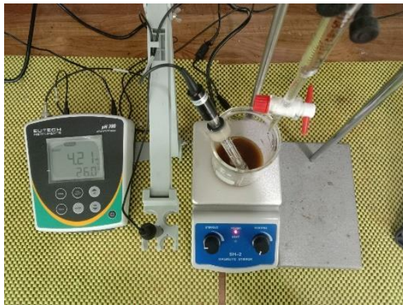
ภาพที่ 2 ทดสอบความเป็นด่างและกรดระเหยง่าย
