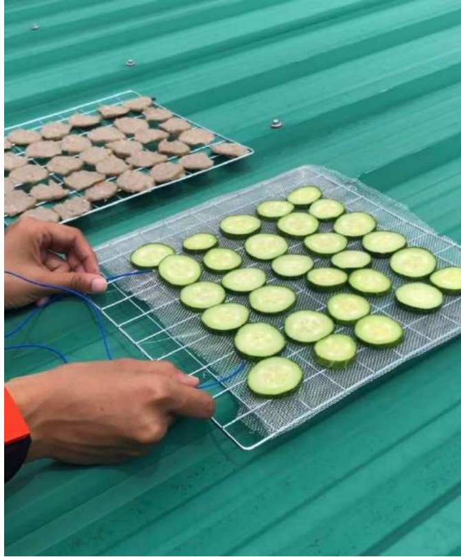
ภาพที่5 การวัดอุณหภูมิผิวบน-ผิวล่าง และอุณหภูมิรอบ ๆ พื้นบริเวณ วัดโดยใช้เครื่องวัดอุณหภูมิThermocouple
