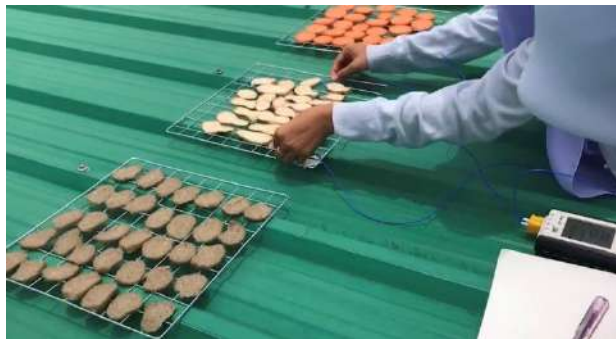
ภาพที่ 1.4 ทำการวัดอุณหภูมิผิวบน - ผิวล่าง และอุณหภูมิรอบ พื้นที่บริเวณ
