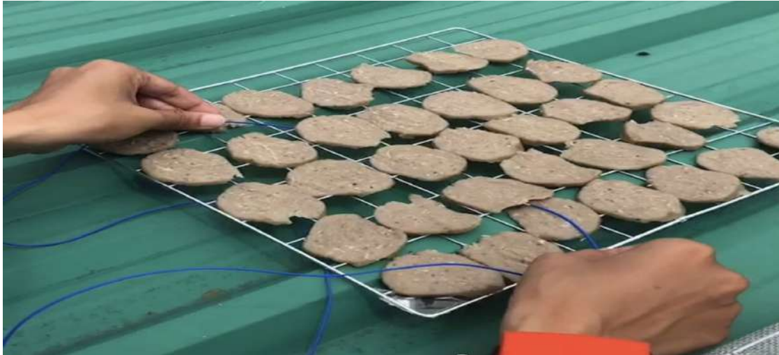
ภาพที่ 5 วัดค่าอุณหภูมิต่างๆ เช่น วัดอุณหภูมิพื้นผิวบน วัดอุณหภูมิพื้นผิวใต้ วัดจุดดับ วัดอุณหภูมิรอบๆบริเวณที่ตากแดด โดยใช้เครื่องมือวัดอุณหภูมิ
