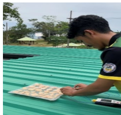
ภาพที่ 2.5 การวัดค่าด้วย Infrared Themometer
